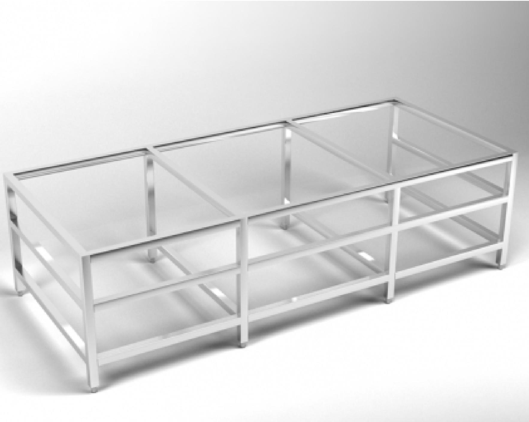
**Bastidor** fabricado en acero inoxidable AISI 304 para encimera fabricada a medida en pulido brillante tubo de inoxidable de 40 x 40 mm con pies regulables.
