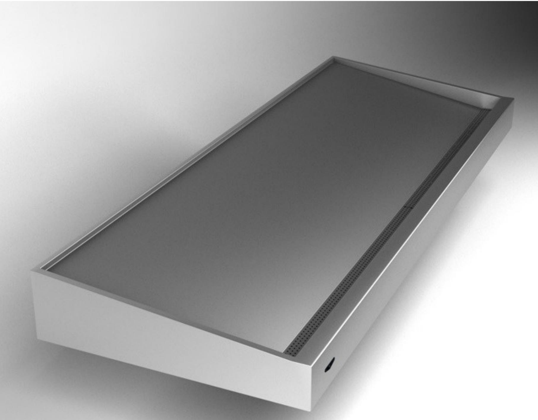
**Encimera de pescadería APBM** construida en acero inoxidable AISI-316 (acero marino) con aislamiento interior por proyección de espuma de poliuretano para evitar condensaciones y aumentar la duración de la capa de hielo. Canal de recogida con filtro anti-escamas, todo soldado sin juntas donde se puedan depositar restos, frente pulido brillante, resto lija.
